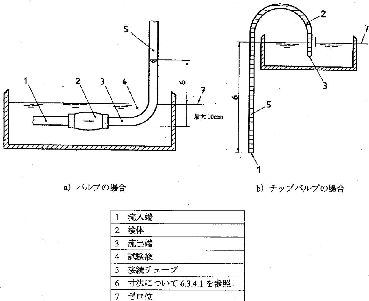
図 2 逆流がないかを試験するバルブの配置
